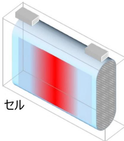
模擬実験により充放電時の電解液成分の偏り(発熱要因)を測定
