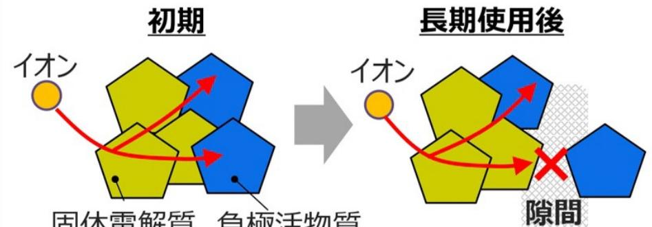
隙間の発生を抑える材料を開発中
