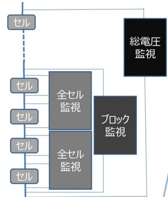
電圧・電流・温度の多重監視により、異常発熱の兆候を検知・未然に防止
